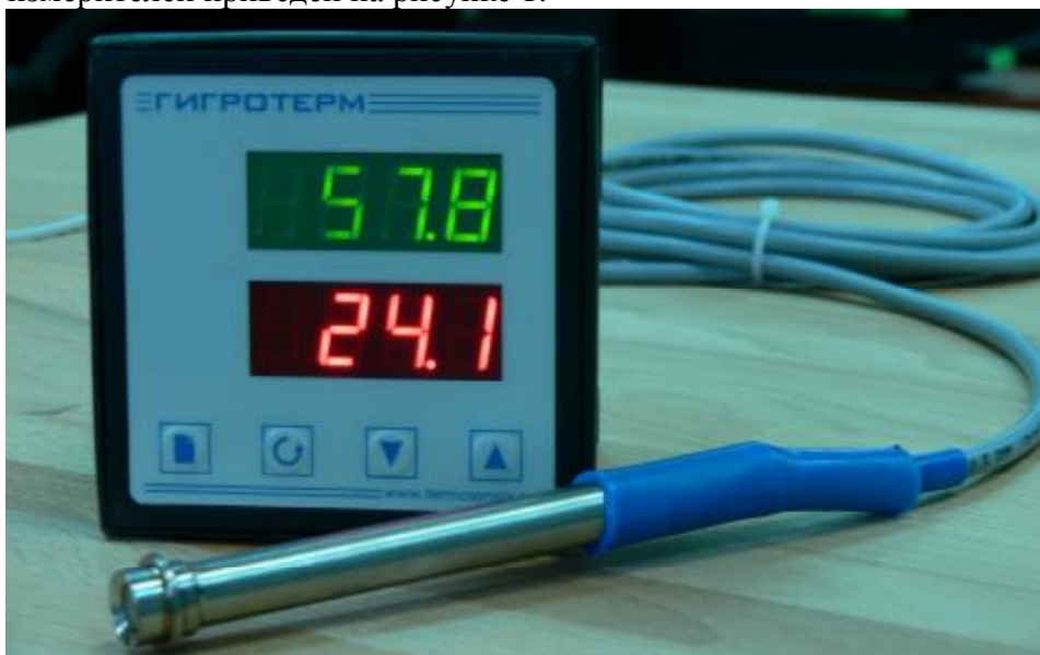
Рисунок 1. Измеритель влажности и температуры «Гигротерм-38».
